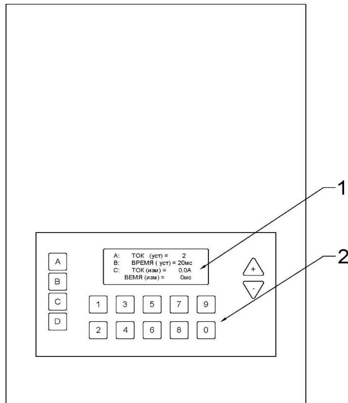
Рис. 3. Верхняя панель пульта управления СИНУС-Т 3600А
